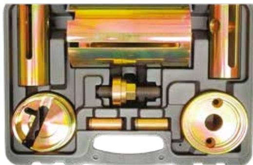
Conjunto de herramientas que permite extraer e instalar el silentblock del brazo de suspensión trasero sin la necesidad de desmontar el brazo.
