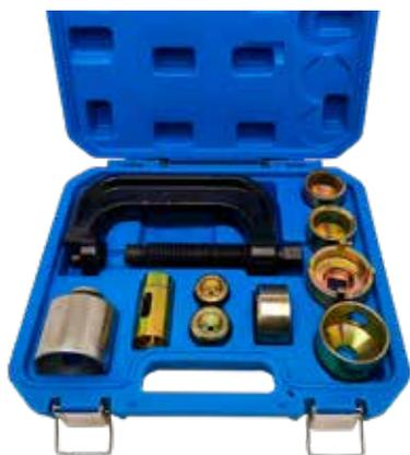
Conjunto de herramientas de 11 piezas que permite la extracción e instalación de las rótulas para vehículos Mercedes. Sin la necesidad de desmontar el brazo de suspensión o el sistema de frenos. Contiene una prensa en "C" con los adaptadores y platos para extraer e instalar las rótulas. También contiene el vaso almenado especial para el Mercedes Clase M, W163 y W164.
