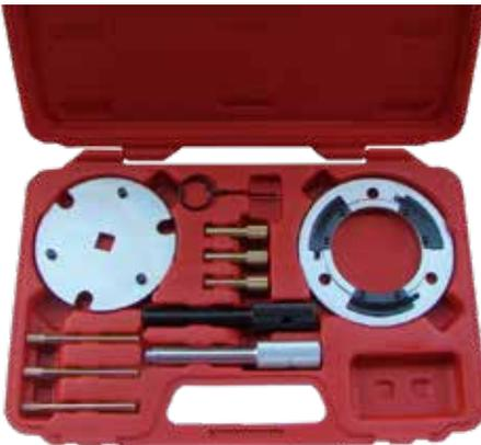
Este conjunto contiene los pasadores para asistir en el cambio de la correa o cadena de distribución de los motores Ford Duratorq 2.0, 2.2 y 2.4 y también los motores PSA/Ford 1.4 y 1.6 HDi. Adicionalmente incluyen las herramientas especiales para permitir quitar la bomba de alta presión diésel sin alterar el puesta a punto de la cadena de distribución.
