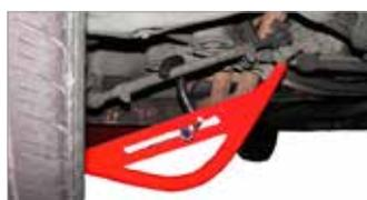
Para el ajuste y sujeción de los componentes del brazo de suspensión
