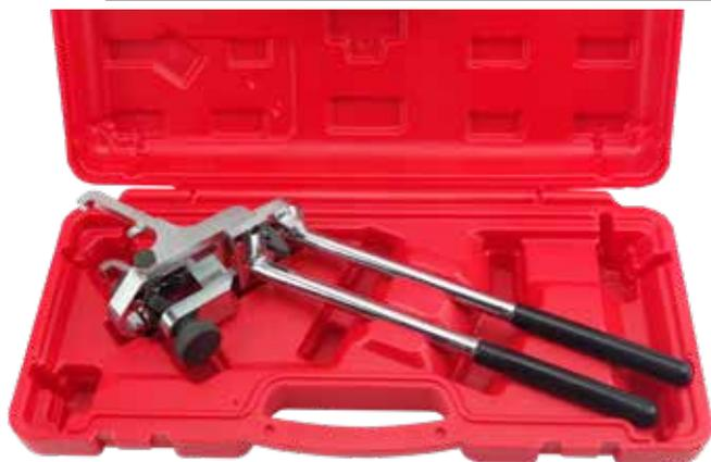
Herramienta para desmontar y volver a montar los muelles de control del eje intermedio utilizados en el sistema VT de los motores gasolina N13 (1.6), N20 (1.6 y 2.0), N26 (2.0) y N55 (3.0) de BMW.
