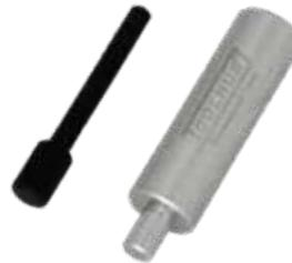
Juego de pasadores para bloquear la polea del árbol de levas en el motor DW10F 2.0 diésel. Se utilizan para mantener los árboles de levas alineados para poder desmontar la bomba de alta presión de diésel.
