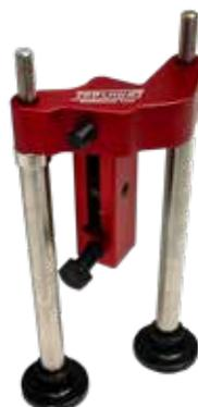
Herramienta especial utilizados para precargar la cadena de distribución con el pretensor.
