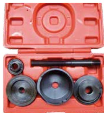
Herramienta para la extracción e instalación del silentblock trasero de la horquilla delantera.
