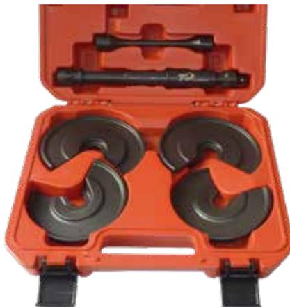
Este nuevo compresor, con enganche de tres puntos y perfil antigiratorio, permite la posibilidad de reemplazar rápida y fácilmente los muelles de las suspensiones triangulares y de multibrazos, sin tener que desmontar el eje. Permite un alto nivel de seguridad y un ahorro de tiempo de mano de obra.
