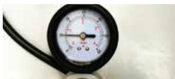
Kit para comprobar la presión en el sistema de refrigeración con conjunto de adaptadores para vehículos industriales. Contiene una bomba de presión y 7 adaptadores con conectores rápidos para un uso fácil. Apto para diagnosticar fugas en el circuito de refrigeración (bomba de agua, mangueras, juntas, radiador etc.).
