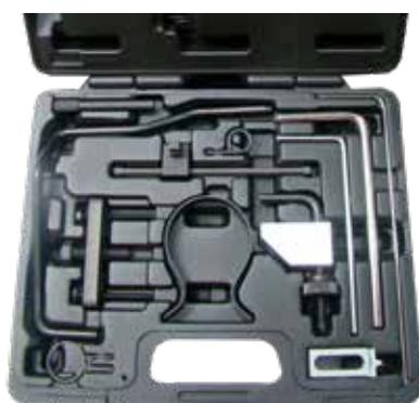
Conjunto de reglaje para el motor 2.0D Blueinjection de Opel basado en el motor BlueHDI del grupo PSA.
