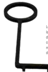
Los motores 1.0 y 1.2 Puretech de PSA utilizan la tecnología "weltbelt" o correa húmeda donde la correa siempre está en contacto con el aceite del motor. Este útil permite medir rápidamente cualquier degradación de la correa
