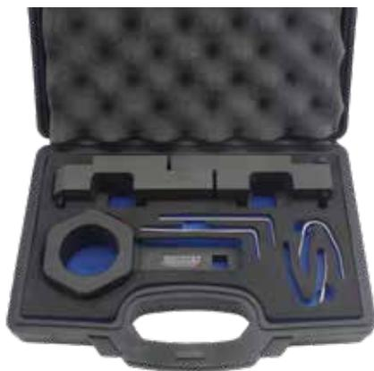
Kit de herramientas para el ajuste de la distribución y cambiar la cadena de distribución del motor 1.6 Ecotec SIDI.
