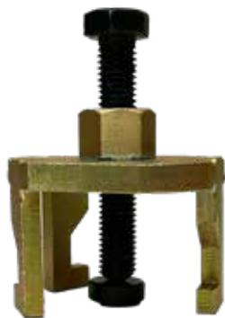
Herramientas especiales para extraer el piñón de la bomba de alta presión diésel y para alinear la tapa delantera de la cadena de distribución.
