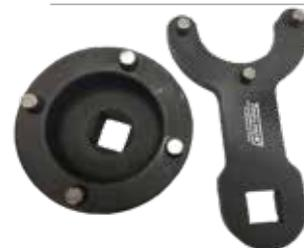
Esta herramienta está diseñada para desmontar e instalar el sello de aceite del cilindro de elevación hidráulica
