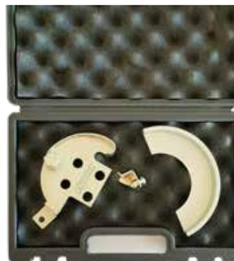
Juego de dos herramientas que facilita la instalación de la correa auxiliar cuyo el ancho de la polea del cigüeñal restringe el acceso. Una pieza se pone en la polea de cigüeñal y la otra en la polea de la bomba de agua y usyo un vaso de 17mm se rota para colocar la correa en las poleas.
