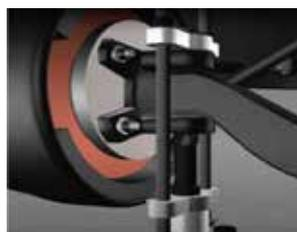
Herramienta diseñada para quitar el perno de fijación del eje de transmisión
