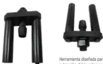
Herramienta diseñada para facilitar la extracción del inyector cuando este se encuentre atascado, tiene dos puntos de apoyo en el bloque.
