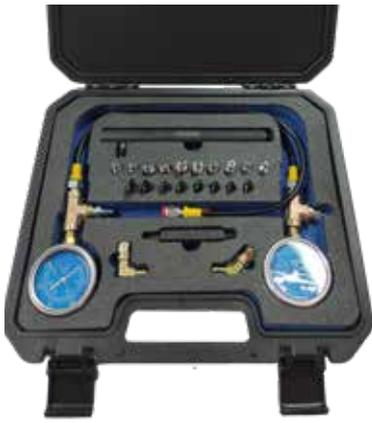
Diseñado para comprobar el correcto funcionamiento del sistema de frenos. Se puede verificar en diferentes puntos en el sistema, desde el cilindro principal, purgadores de frenos, bomba. Dispone de dos manómetros con un rango de trabajo de 0 a 250 kg/cm<sup>2</sup> con 22 adaptadores para las conexiones.
