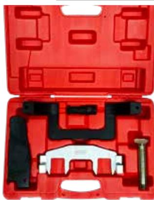
Para motores Mercedes de gasolina 1.8 montados entre 2002 y 2018. Contiene la herramienta de sujeción del árbol de levas, el puente de retención de la cadena, la cuña del tensor, el myril para el tensor y una llave para ellos ajustadores de los arboles de levas.
