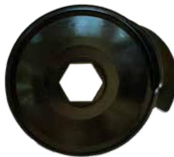
Herramienta para instalar la correa de la bomba de agua en los motores 1.0 y 1.2 Puretech de gasolina del grupo PSA. Monte la herramienta en la polea de la bomba de agua y gire el cigüeñal hasta que la correa se coloque en la polea
