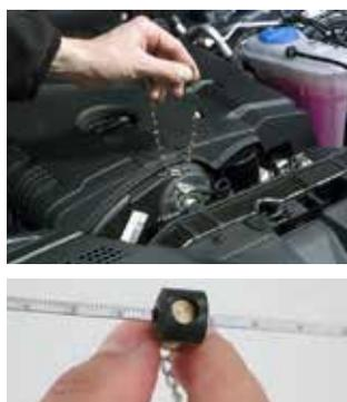
Para medir el nivel de aceite en motores VAG con sistema electrónico de nivel de aceite, y para calibrar el cuadro.
