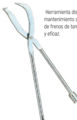
Herramienta diseñada para realizar el mantenimiento o extracción de los muelles de frenos de tambor de una manera rápida y eficaz.
