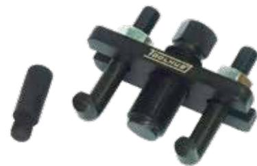
Permite quitar la bomba diésel sin disturbar la sincronización de la cadena de distribución del motor 2.2 diésel de Ford usado en el Ford Transit y Land Rover Defender.
