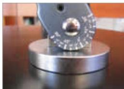
Quando se reemplazan los amortiguadores, es necesario proceder a la regulación de la caída. Este útil evita tener que realizar el alineado.
