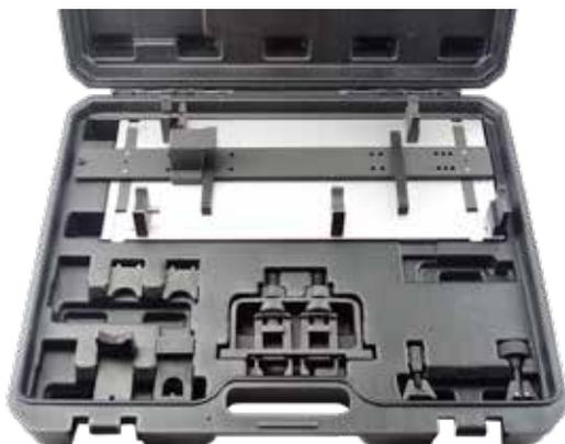
Herramienta especial que permite montar los árboles de levas dentro de su marco de retención para poder montarlos correctamente.
