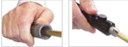
Se utiliza para eliminar de los tubos de freno las rebabas permitiendo al sistema de frenos trabajar de manera eficiente y por más tiempo.
