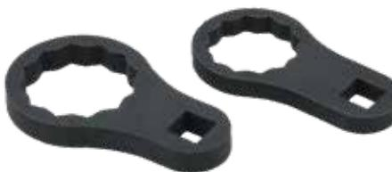
Diseñadas para la extracción e instalación de las tuercas de las rótulas superiores e inferiores en los Mercedes con suspensión de doble horquilla a partir del 2015. Ambas son multicaras y permite el paso del pasador de la rótula.
