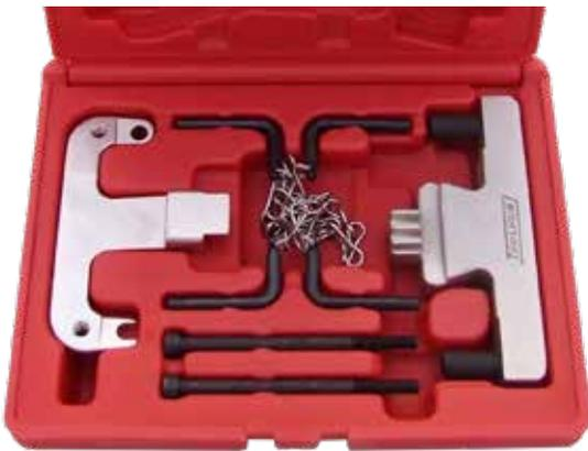
Este kit cubre una amplia gama de motores Mercedes de diésel y gasolina desde 1984. Contiene dos modelos de bloqueador de volante de motor y pasadores de bloqueo de árbol de levas.
