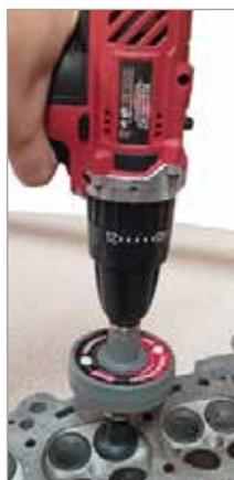
Para utilizar con taladro eléctrico. Esta herramienta se coloca en el portabrocas (8mm), permite lapear válvulas de forma rápida y eficaz.
