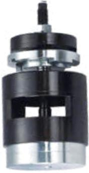
Herramienta de taller necesaria a la hora de llevar a cabo los procesos relacionados con la extracción e instalación de los silentblocks en el brazo de suspensión trasero. Diseñada especialmente para BMW X5
