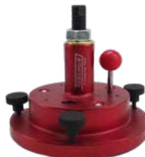
Herramienta especial para poder instalar el retén de cigüeñal y asegurar que el sensor esta correctamente alineado.
