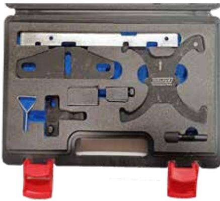
Conjunto de reglaje para una gama amplia de motores gasolina de Ford.
