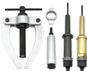
Diseñado para la extracción de las camisas de los inyectores, de cobre o acero, de la parte superior de la culata de los motores de los camiones Volvo FM12, mediante un sólido y robusto extractor de 2 pinzas.
