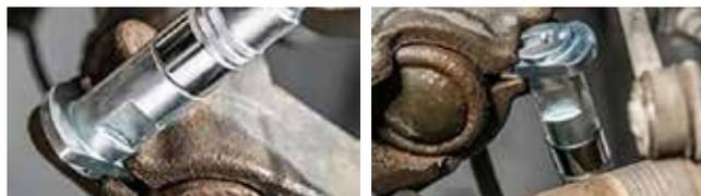
Herramienta diseñada para liberar las manguetas. Por el paso del tiempo suele ser difícil liberarla y esta herramienta nos permite no tener que golpear con un martillo la suspensión.
