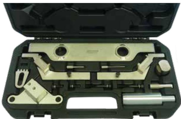
Conjunto de herramientas para mantener la sincronización correcta de los motores 1.6 y 1.8 de gasolina de los motores 2.0 y 2.4 con turbo.
