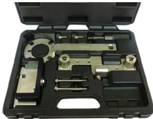
Este kit contiene las herramientas especiales para alinear los arboles de levas y cigüeñal durante la reparación de la unidad de válvulas variables y el desmontaje e instalación de los arboles de levas. También contiene la llave 9859 para sujetar la polea de cigüeñal.
