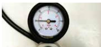
Kit para comprobar la presión en el sistema de refrigeración con conjunto de adaptadores para vehículos industriales. Contiene una bomba de presión y 7 adaptadores con conectores rápidos para un uso fácil. Apto para diagnosticar fugas en el circuito de refrigeración (bomba de agua, mangueras, juntas, radiador etc.).
