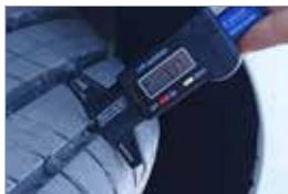
Herramienta diseñada para comprobar el desgaste del neumático.
