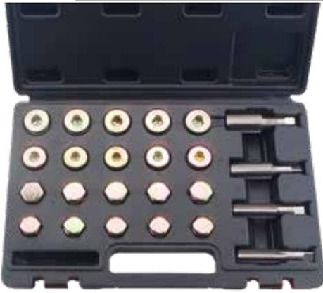
Maletín con todo lo necesario para la reparación de roscas de tapones roscados de vaciado del aceite sin la costosa sustitución del cárter. Es muy fácil de usar, solamente hay que eliminar la rosca dañada con el macho de roscar y ampliarla al siguiente tamaño
